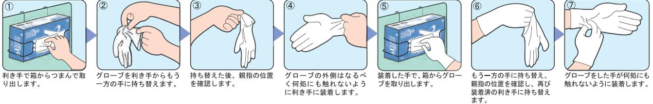
グローブの着け方・外し方は感染予防の点からも非常に重要です。着用時はグローブの表面を汚染しないように、外す際は、汚染したグローブの表面に触れないようにする配慮が必要です。
