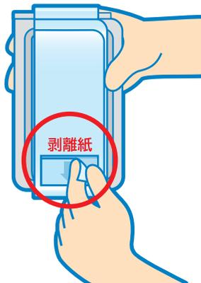
固定台の裏側の剥離紙を剥がし、粘着部分を下に向けます。
